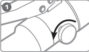
**1** Поверните винт сброса давления в положение «Открыть».
